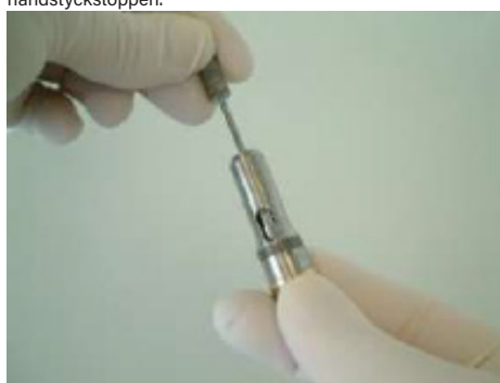
Steg 4: Sätt i ett slipstift i spännmekanismen, för att förhindra rotering av handstycksskaftet
