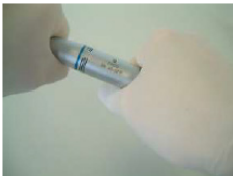
Steg 1: För bättre grepp, ta på skyddshandskar och skruva av handstyckstoppen från motorn.
