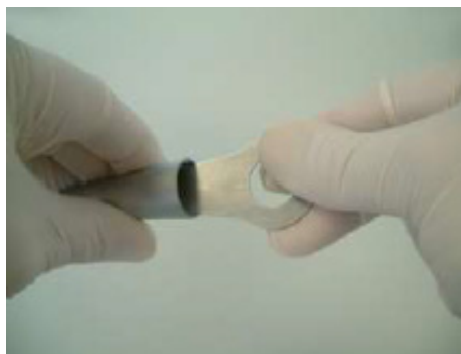
Steg 2: Använd verktyget för att skruva ur låsmuttern ur handstyckstoppen.
