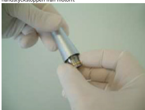
Steg 3: Dra ut spännmekanismen ut handstyckshylsan
