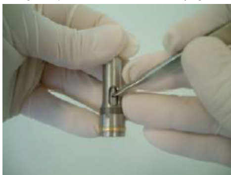
Steg 7: Skjut med pincetten tillbaka dammskyddsringen till sin ursprungliga position.
