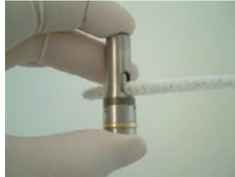
Steg 6: För en pipensare genom smutskammaren och avlägsna på detta sätt den ansamlade smutsen.
