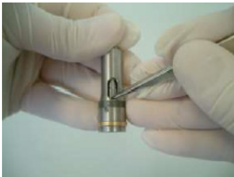
Steg 5: Skjut med hjälp av en spetsig pincett dammskyddsringen i riktning mot slipstiftet tills smutskammaren blir synlig.
