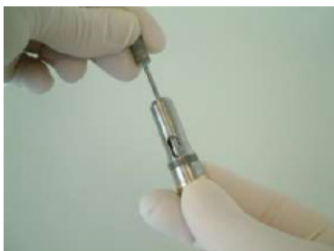
Steg 4: Sätt i ett slipstift i spännmekanismen, för att förhindra rotering av handstycksskaftet
