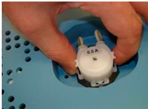
Steg 2: Lyft ut pumpkassetten så snart pumpkassetten har avlägsnats från maskinens hölje.
